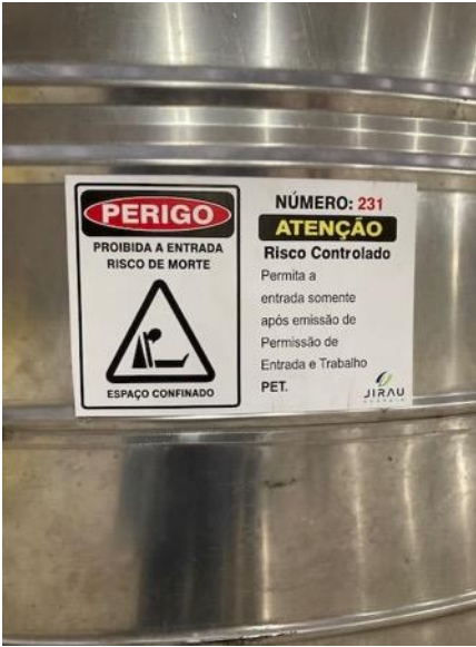
Foto 56: Etiqueta de aviso de espaço confinado
